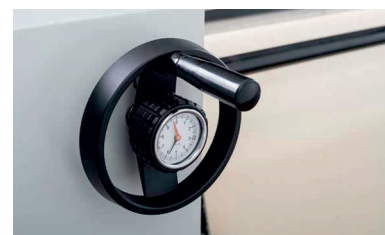
Regulacja naprężenia pasa filcowego za pomocą manometru
