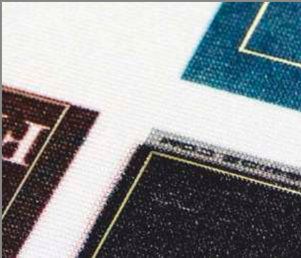
Perfect Laser cutting result. No fray Perfekcyjny rezultat cięcia laserem, bez strzępienia
