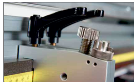
Precyzyjna regulacja docisku noża (w zależności od rodzaju materiału)
