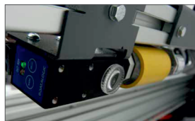
Zaawansowany czujnik znaczników cięcia
