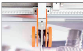
Pojedynczy lub podwójny (opcja) nóż obrotowy do cięcia wzdłużnego
