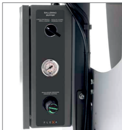
Płyta kontrolująca odpowiednie napięcie mediów
