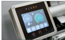
Panel sterujący do automatycznego wyrównywania krawędzi w pionie
