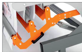
Zintegrowany pneumatyczny system buforowania z przeciwwagą, system utrzymuje media zawsze napięte, co zapobiega rozdarciu
