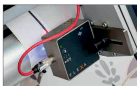
Optyczny czujnik pionowego wyrównywania krawędzi
