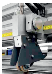
Nowe obrotowe noże do cięcia wzdłużnego z wąską linią cięcia pojedyncze lub podwójnych (opcja)
