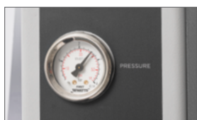
Manometr do wyświetlania ciśnienia górnego wałka
